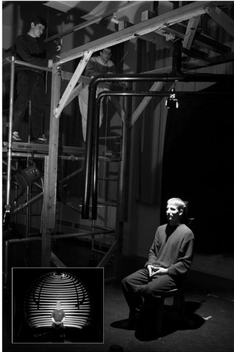
图 8 Light Stage 装置<sup>[29]</sup>
